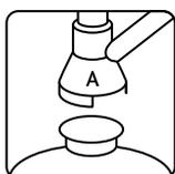
Используйте ПЭТ-кегу только с разливочными головками соответствующего типа
