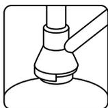
Оденьте и отцентрируйте разливочную головку. Если разливочная головка одевается с трудом, значит она неисправна!
